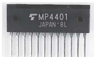
図 10 FET モジュール (左 : 2.54 mm ピッチ、 右 : 1.27 mm ピッチ)
