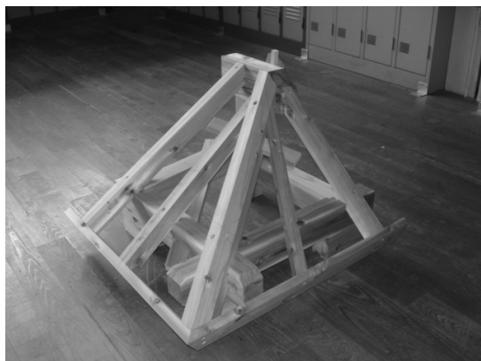
写真1 競技課題「振隅木庇小屋組」
