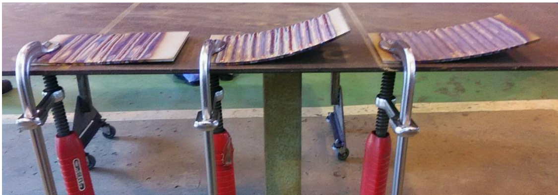
写真. ビード置き実施後における母材変形量の比較
