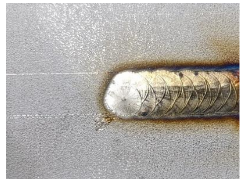
写真. ノンフィラ ウィービング
