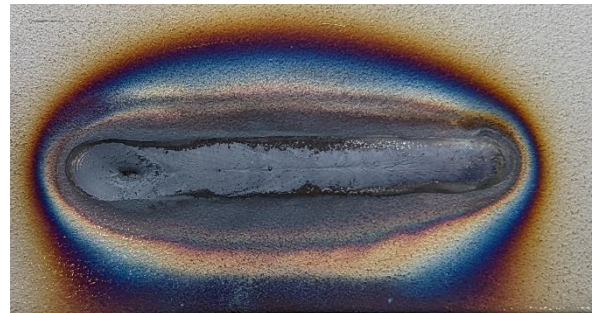
写真. 溶接部の著しい酸化
