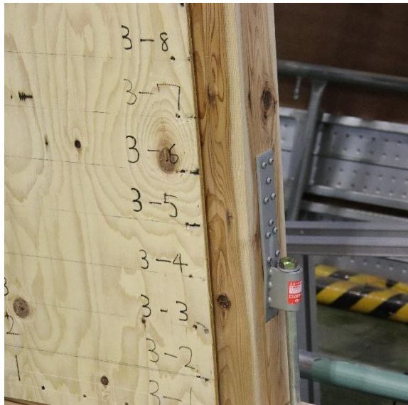
②引張力によるHD金物の塑性変形の様子
