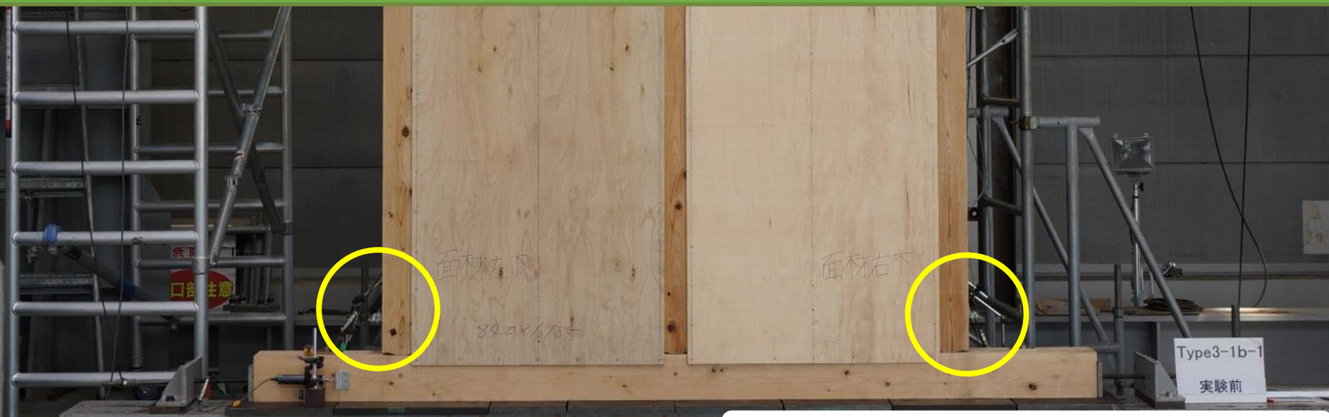
図21 無載荷柱脚固定式試験法の様子
