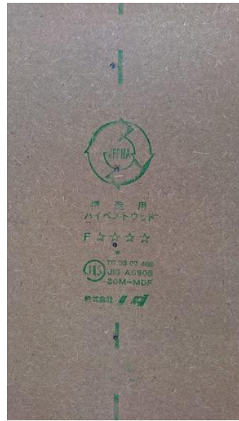
ハイベストウッド 倍率：2.5、3.0、4.0 ※施工方法によって異なる
