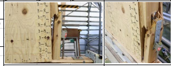
①面材の割裂の状況（引張側） ②釘のパンチングア構面材座屈の状況（引
