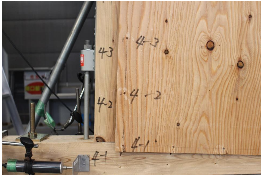
②釘のパンチング状況
