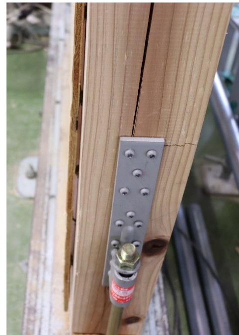
③HD金物のビスによる引き抜き力による柱の直交破断の様子
