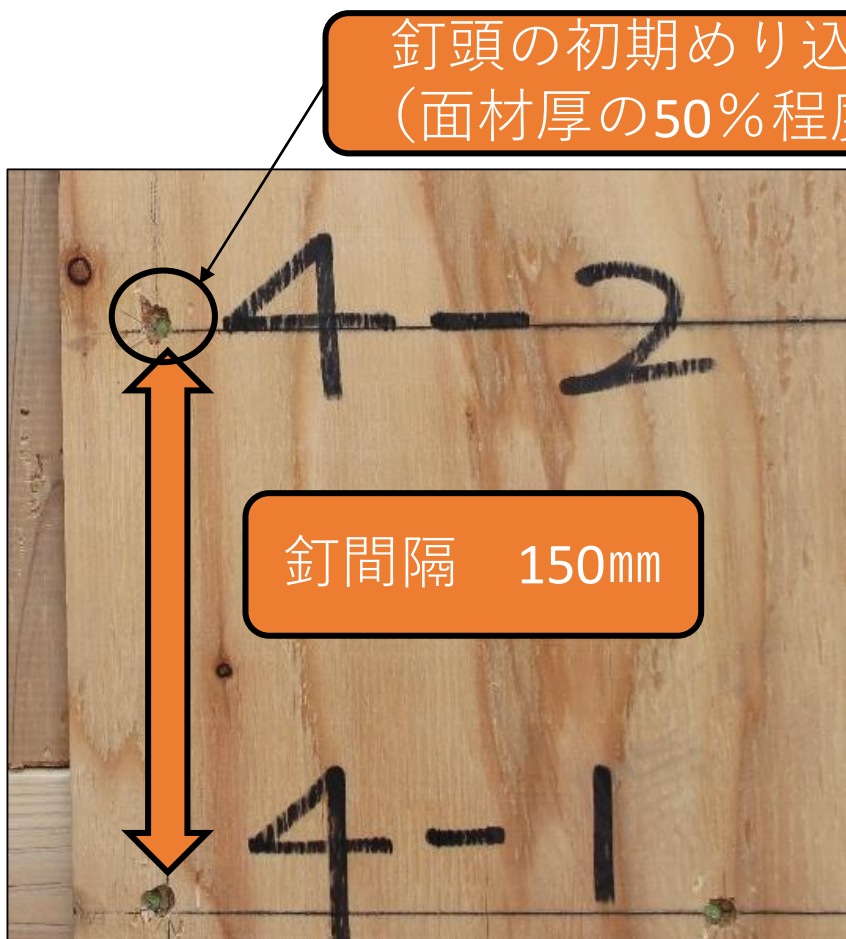
図63 施工不良である釘頭の初期めり込みが有る試験体
