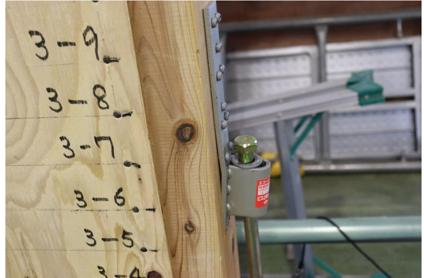
③引張力によるHD金物の塑性変形の様子
