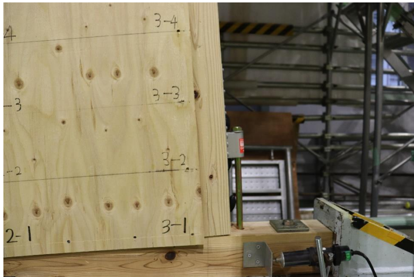
②釘のパンチングシア状況
