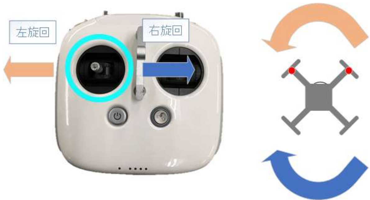
図 17 スティック操作② 左右旋回
