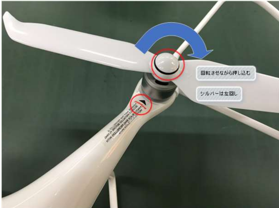
図 12 部品の取り付け③ プロペラ
