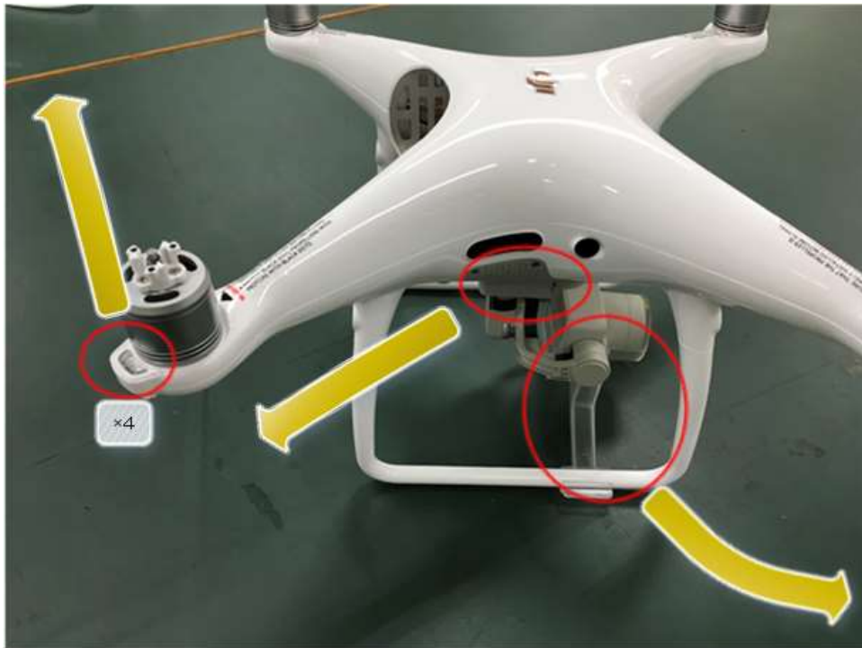
図 10 部品の取り付け① ストッパーの取り外し
