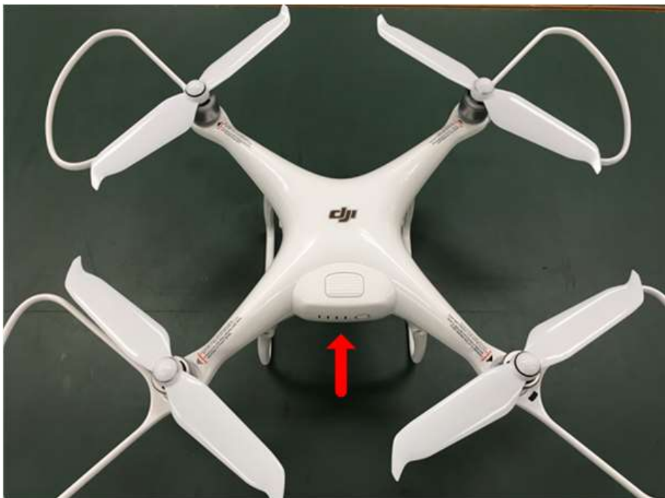
図 13 部品の取り付け④ バッテリー
