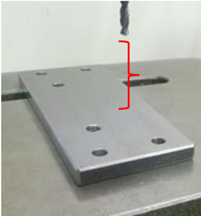
材料固定テーブルとドリルとの距離が離れている
