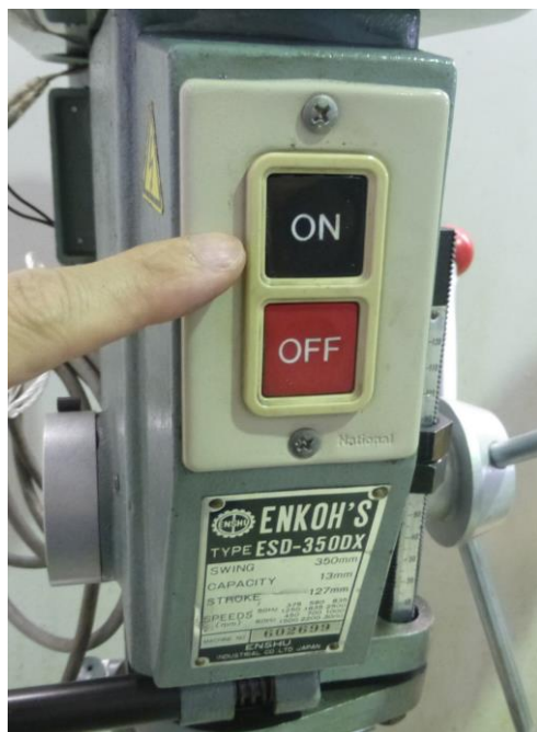
電源の起動と停止を確認
