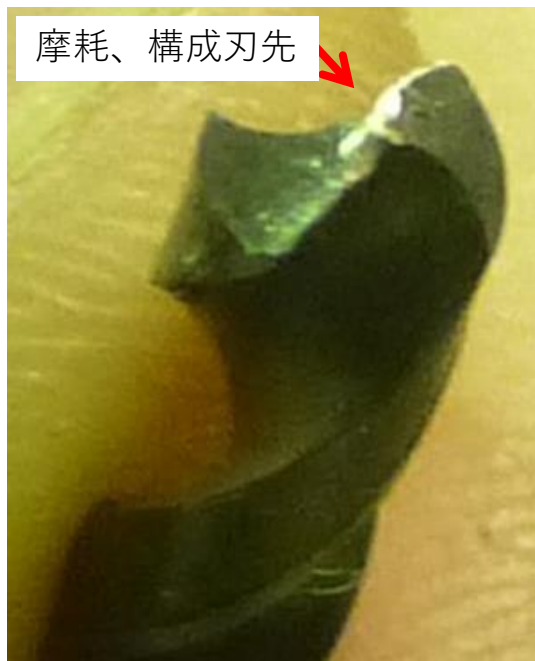
ドリルの先端の摩耗
