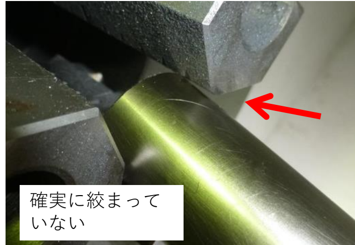
材料の振れを確認
