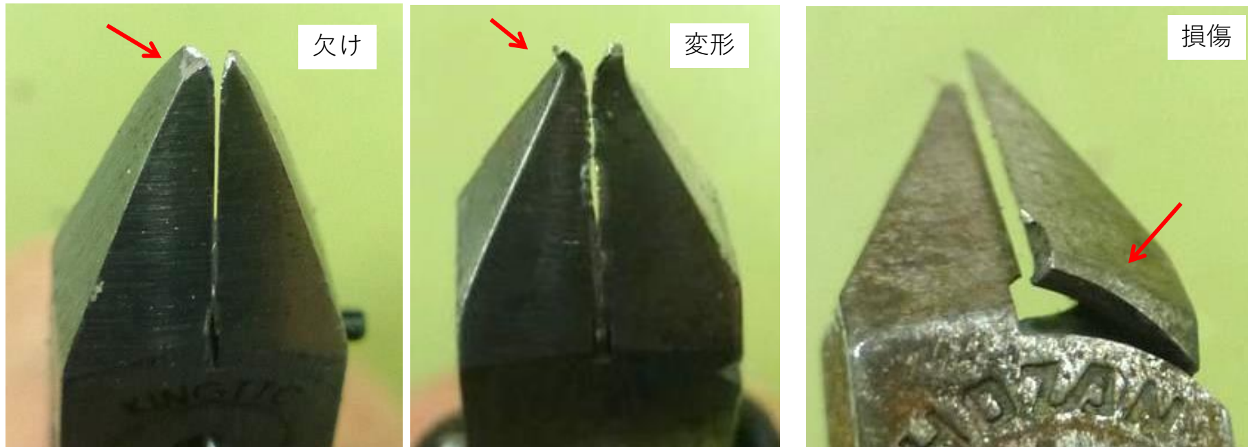
ニッパー刃先（クチバシ）の損傷
