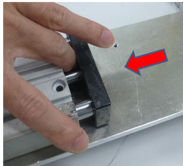
ピストンロッドが戻るときに指を挟む
