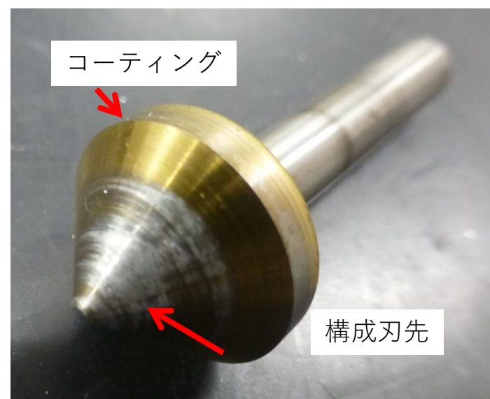
面取り工具のコーティング層の剥離と構成刃先
