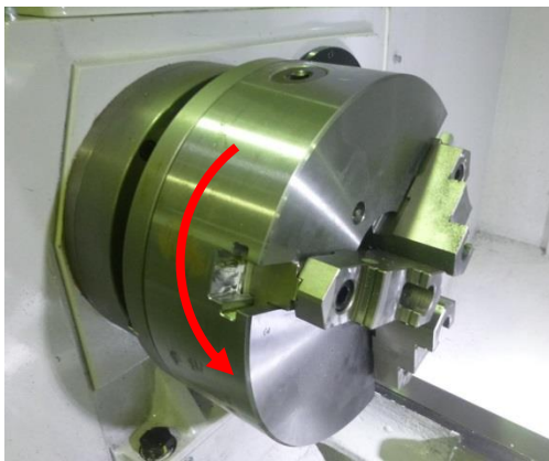
旋盤主軸の回転
