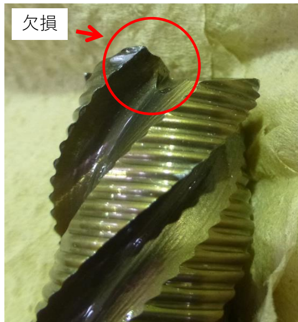
工具刃先の欠け状態
