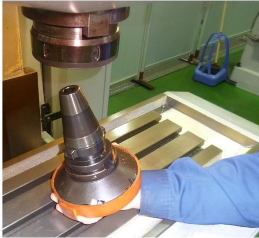
切削工具の取り付け
