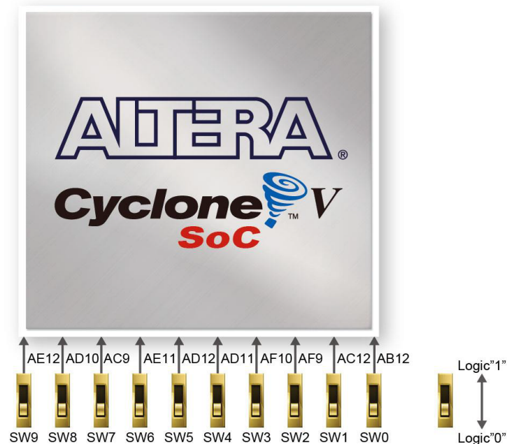
図 2.81 DE1-SoC のスライドスイッチの接続図 [6]
