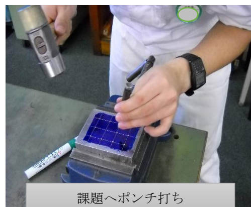
ハンマ+センターポンチの拡大写真
