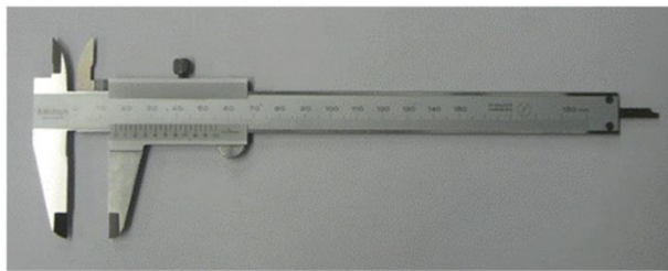
名称:ノギス 測定範囲:0~150mm 測定単位:0.1mm
