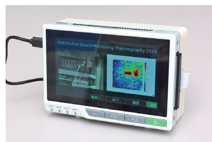
図22 異常温度検知システムの外観
