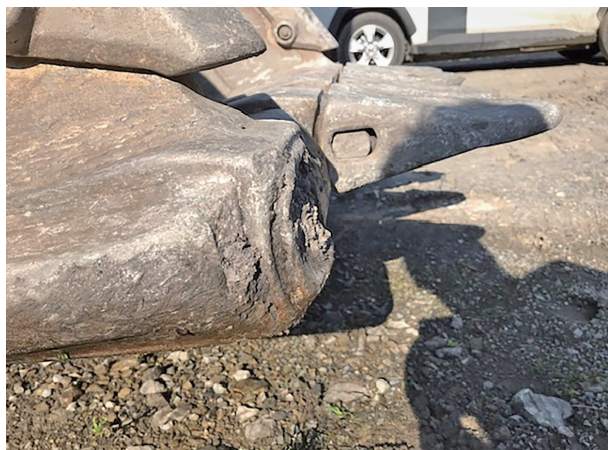
図3 バケットツースアダプタ折損
