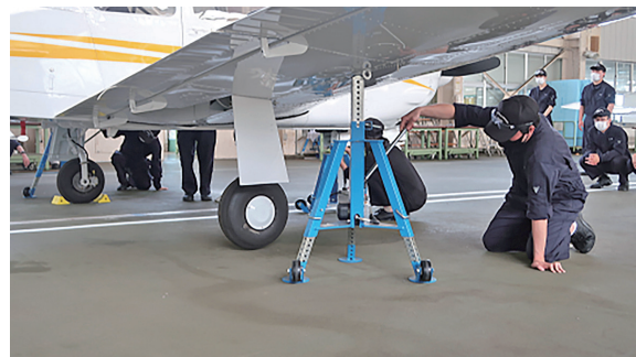
図11 機体整備におけるジャッキアップ
