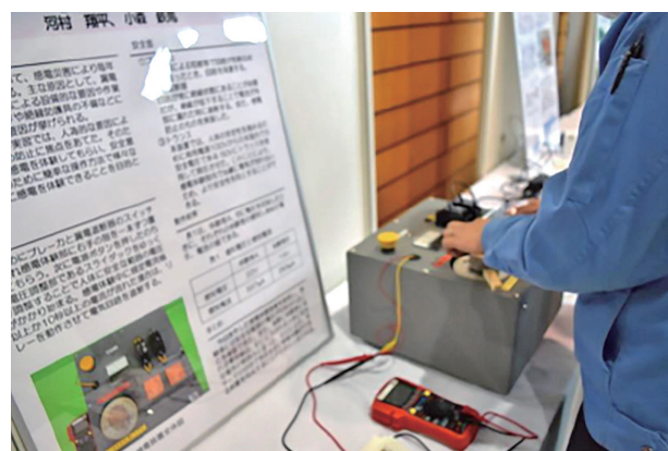
図10 感電体験装置を操作している様子
